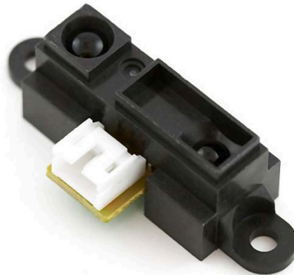
Figura 3.3: Sensor de distância infra-vermelhos Sharp GP2D120.
